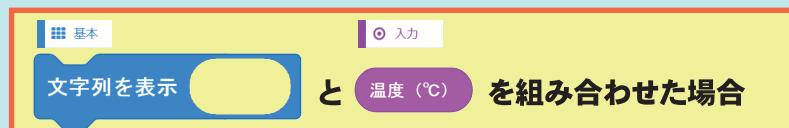
micro:bit の LED に、測った温度を表示させることができます。
